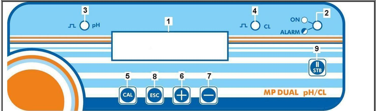
1. Display LCD 16 x 2 con retroiluminación
