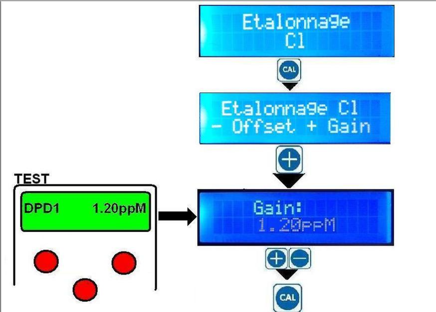
**REGLAGE DU GAIN.** Nous vous recommandons de calibrer le gain après au moins 2,3 heures de travail dans des conditions optimales ou vous pouvez aussi faire un étalonnage initial après l'installation de la sonde et de la pompe, puis revenir en arrière pour affiner le calibrage après 24 heures.
