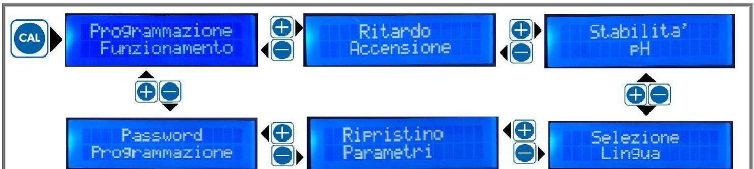
Premendo il tasto **CAL** si entra in programmazione. Si naviga dentro il menu con i tasti + e -. Si entra nei sottomenu premendo il tasto **CAL**
