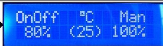
Durante il normale funzionamento è possibile visualizzare le misure o le portate di dosaggio attualmente effettuate da DUAL (oppure l'attività % della presa di corrente) semplicemente premendo il tasto ESC. Si passa dall'una all'altra visualizzazione premendo ESC. (Vedere la figura soprastante).
