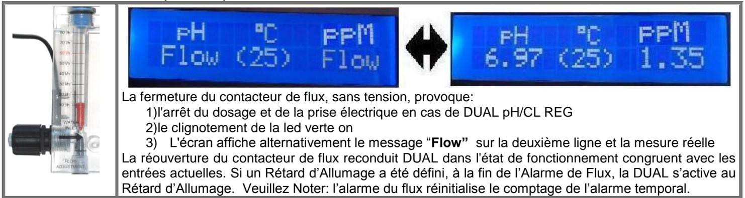
La fermeture du contacteur de flux, sans tension, provoque:
