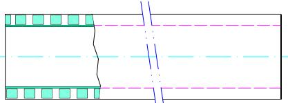
Sottostrato in HAYCLOR® spirale in PVC rigido a sezione quadrata.
