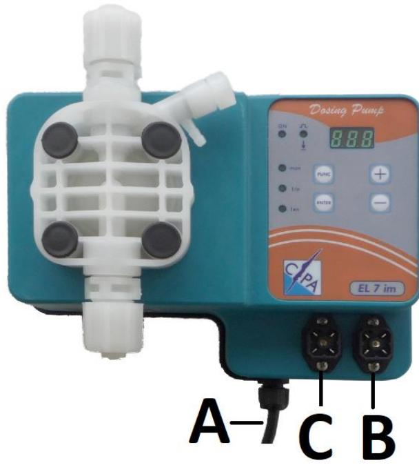
**I** Il cavo di alimentazione della pompa esce dal pressacavo A di figura. Questo va collegato con la rete di alimentazione elettrica 230 V, 50Hz.
