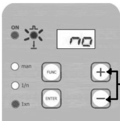
**I** Per visualizzare la presenza o meno della memorizzazione degli impulsi da contatore premere contemporaneamente i tasti + e -. Al momento del rilascio il display torna a visualizzare il valore n.
