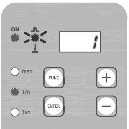
**I** Per ogni N impulsi ricevuti da contatore la pompa fa 1 iniezione.
