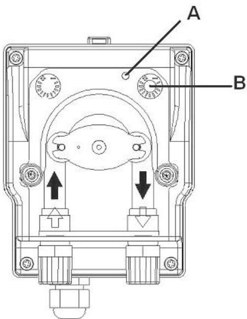
**I** Portata regolabile 0-100% tramite **trimmer B** di figura.
