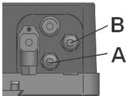
**I** Il cavo di alimentazione della pompa esce dal pressacavo A di figura. Questo va collegato con la rete di alimentazione elettrica 230 V, 50Hz.
