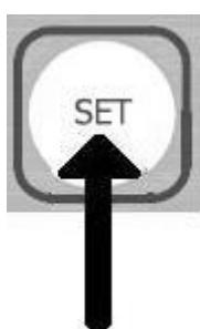
**I** Per visualizzare il valore dei parametri settati (CAP, FH) premere brevemente il tasto SET. I 3 led iniziano a lampeggiare ed il display mostra per 3 secondi la scritta CAP ed il suo valore, poi mostra per 3 secondi la scritta FH ed il suo valore. I 3 led si spengono ed il display torna nella visualizzazione dell'attuale funzionamento.
