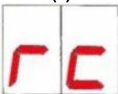
**I** Se alla fine della calibrazione il display mostrerà la scritta "rc", premere il tasto CAL per uscire dalla calibrazione e tornare in lettura. Ripetere la procedura di calibrazione e se dopo il secondo tentativo comparirà ancora la scritta "rc", cambiare la sonda che non è in buona salute e va sostituita.
