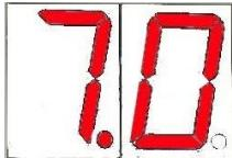
**I** Premere il tasto Cal per 3 secondi , sul Display il valore di 7.0 comincerà a lampeggiare. Quando la calibrazione della sonda sarà terminata, il valore sul Display diventerà fisso
