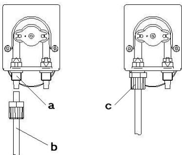
**F Aspiration:** Raccorder le tuyau d'aspiration (b) au raccord d'aspiration (a). Visser l'embout (c).
