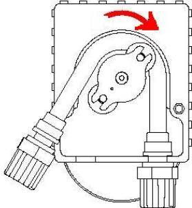
**F** Enlever le couvercle transparent en dévissant les deux vis. Enlever le vieux tube en débloquant d'abord le raccord de gauche. Faire tourner le porte-galet dans le sens de la flèche jusqu'au raccord de droite afin de libérer le tube péristaltique.
