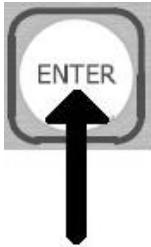
**I** Premere ENTER per memorizzare i nuovi parametri di calibrazione e tornare in misura. (Se il tasto ENTER non viene premuto nel termine di 180 secondi, i nuovi parametri di calibrazione non vengono memorizzati). Il led CAL si spegne ed il display torna in misura.
