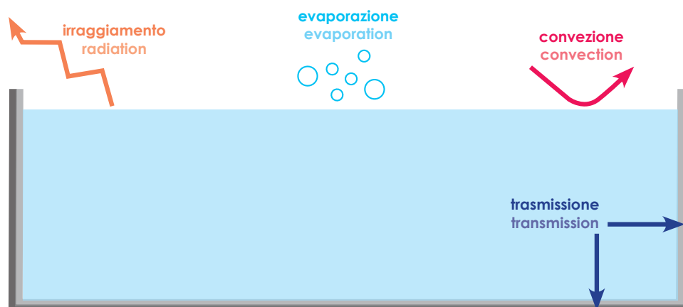
Fig 1: Dispersioni termiche di una piscina Fig 1: Heat loss of a swimming pool
