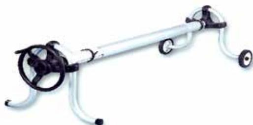
Piedi a forma d'OMEGA, in tubo d'alluminio anodizzato di Ø 40 mm, in testata due flange in resina di sintesi armata di fibre di vetro con cuscinetti integrati. Un piede fisso, un piede mobile equipaggiato di due ruote di Ø 170 mm. Dispositivo di bloccaggio dell'asse. Altezza dell'asse 360 mm, diametro dell'asse 95 mm. Consegnato con 13 cavi elastici.
